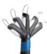
przenośna lampa typu LED; 24 LED + latarka 5 LED; korpus z gumowanego tworzywa odpornego na uderzenia; posiada magnes; Czas świecenia do 4h
