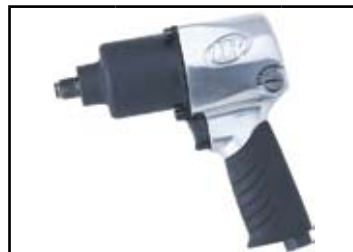
klucz udarowy 1/2" 610 Nm; twinhammer; 8000 obr/min; 2,63 kg
