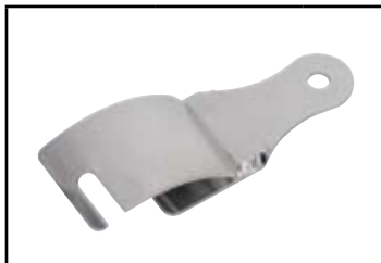
przyrząd do montażu opon motocyklowych; montowany na rant felgi (za szprychę); zapobiega zsuwaniu się opony przy montażu
