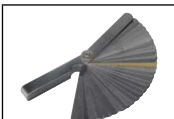
szczelinomierz metryczny i calowy 32 listki (0,0015"-0,035"; 0,038-0,889mm)
