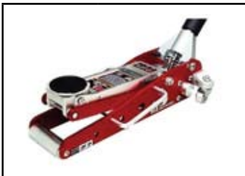
podnośnik przejezdny żaba aluminiowa; udźwąg: 1,5 t; wys. podnoszenia: 85-445mm; system szybkiego unoszenia bez obciążenia
