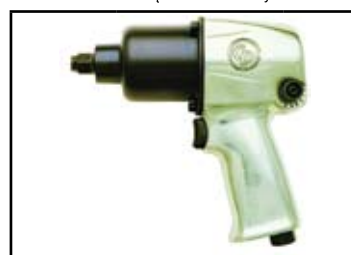
klucz udarowy 1/2"; moment roboczy 34-542Nm; moment max. 746Nm; 1300 obr/min; pobór powietrza 538l/m; waga: 2.5 kg + zestaw nasadek 14 szt. (1/2", rozmiary: 10, 11, 12, 13, 14, 15, 16, 17, 18, 19, 21, 26, 27mm)
