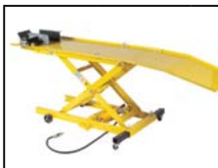
podnośnik hydrauliczno-pneumatyczny; udźwieg 360 kg; wymiary 2350mmx480mm; wysokość podnoszenia 220-780mm
