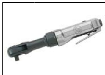
klucz kątowy zapadkowy 3/8"; moment roboczy: 14-68Nm; moment max. 68Nm; prędkość obrotowa 160 obr/min; rozmiar śruby: 10mm; pobór powietrza: 120l/m; waga: 1,19 kg
