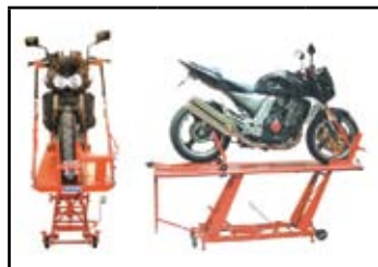
podnośnik hydrauliczny; udźwieg 400 kg; wym. 2100x620 mm; wys. podnoszenia 200-800 mm
