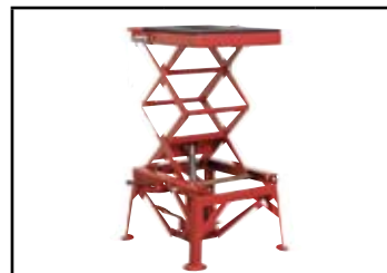
podnośnik hydrauliczny nożycowy do obsługi motocykli off-road; udźwieg 135 kg, wysokość podnoszenia 355-895mm
