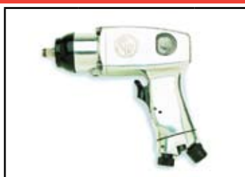
klucz udarowy 3/8"; moment roboczy 7-68Nm; moment max. 102Nm; rozmiar śruby: 10mm; pobór powietrza: 71l/m; waga: 1.2 kg
