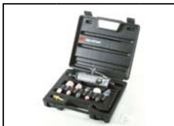
szlifierka pneumatyczna czołowa z zestawem bitów; uchwyt 6mm; prędkość obrotowa 22000 obrotów/min; 0,32kW; waga 0,6 kg
