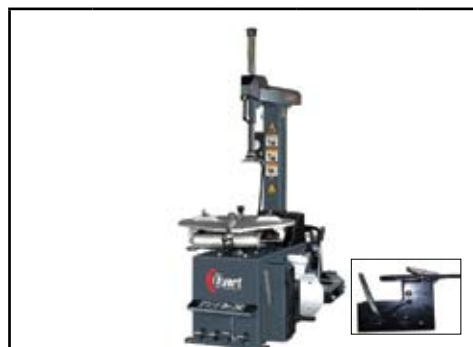
automatyczna montażownica 885IT; pneumatyczny odchyl ramienia do tyłu; wsteczny bieg; pneumatyczne blokowanie głowicy; zakres: 12°-23° (mocowane od wewnątrz); 10°-20° (mocowane od zewnątrz); wersja EVERT885IT-2 posiada dodatkowo 2 prędkości stołu
