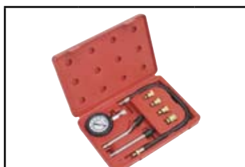
przyrząd do pomiaru ciśnienia sprężania w silnikach benzynowych; skala pomiaru do 300 PSI; wymienne końcówki 10, 12, 14, 18mm
