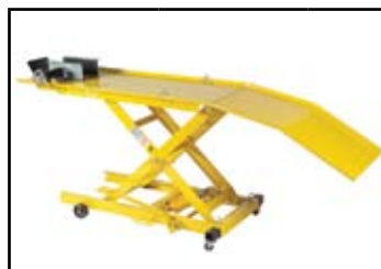
podnośnik motocyklowy hydrauliczny; udźwieg 300 kg; wymiary 1350mmx480mm; wysokość podnoszenia 220-780mm
