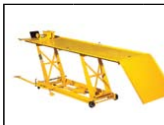
podnośnik hydrauliczno-pneumatyczny, zalecany do ciężkich motocykli, udźwieg 453 kg, wymiary 1800x780mm, wysokość podnoszenia 220-680mm
