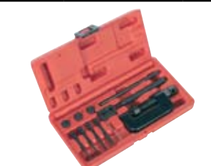
zestaw narzędzi do rozpinania i łączenia wszystkich rodzajów łańcuchów; zakres 35-630; dostarczany z praską, zestawem pinów i akcesoriów
