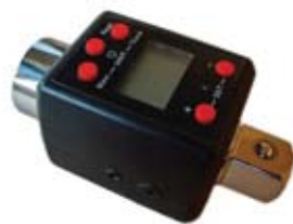
adapter dynamometryczny, cyfrowy; 3/8"; zakres 27-135Nm
