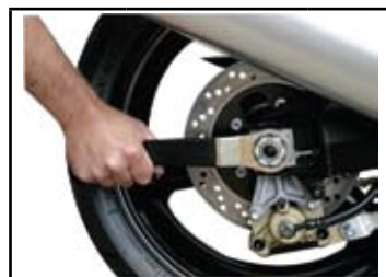
klucz do odkręcania tylnego koła; 32mm
