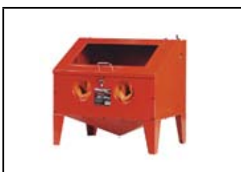
piaskarka stacjonarna; pojemność kabiny: 0,19m 3 ; max. przepływ pow.: 13 cfm; ciśnienie robocze: 4-8 bar; wymiary: 710x760x510mm
