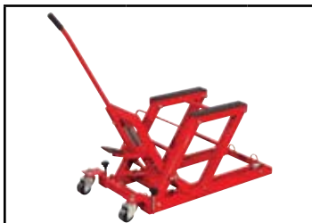
podnośnik nożycowy hydrauliczny; obsługa motocykli i ATV; udźwąg 550 kg; wysokość podnoszenia 130-435mm
