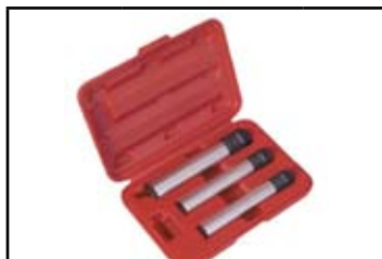
nasadki do świec, 3/8"; rozmiar 14, 16, 21mm; z ograniczeniem momentu: 19, 20, 25Nm; 12-kątne
