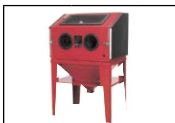
piaskarka stacjonarna; pojemność kabiny: 0,33m 3 ; max. przepływ powietrza 18 cfm; ciśnienie robocze: 4-8 bar; wymiary: 1500x950x730mm
