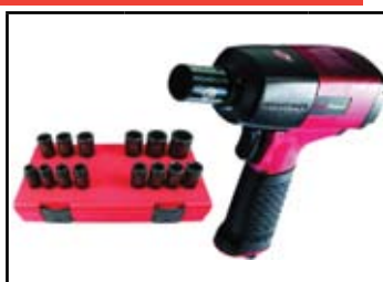
klucz udarowy 1/2"; moment roboczy 300-800Nm; moment max: 1050Nm; pobór powietrza: 13,6l/s; waga: 2kg + zestaw nasadek udarowych 14 szt. 1/2"
