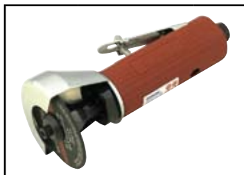
przecinakarka tarczowa: rozmiar tarczy 75mm; prędkość obrotowa: 22000 obr/min; pobór powietrza 115 l/min; waga 0,9 kg
