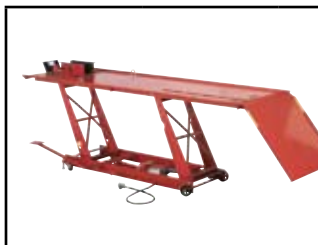
podnośnik motocyklowy pneumatyczno-hydrauliczny; udźwieg 390 kg; wymiary 2200x690mm; wysokość podnoszenia 190-710mm
