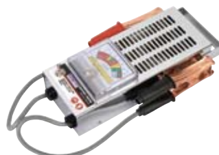
tester akumulatorów metodą obciążeniową; sprawdzenie poziomu naładowania akumulatora przez pomiar napięcia na nim po zakończeniu testu obciążeniowego
