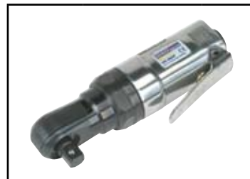
klucz kątowy zapadkowy 3/8"; bardzo mały, do trudno dostępnych miejsc; moment max. 34Nm; pobór powietrza 67l/m; długość: 140mm; waga: 0,5 kg
