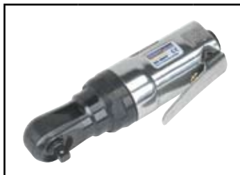
klucz kątowy zapadkowy 1/4", bardzo mały, do trudno dostępnych miejsc; moment max. 34Nm; pobór powietrza: 67l/m; długość: 140mm; waga: 0,5 kg
