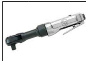
klucz kątowy zapadkowy 1/2"; moment roboczy: 14-68Nm; moment max. 68Nm; rozmiar śruby: 10mm; pobór powietrza: 120l/m; waga: 1,1 kg
