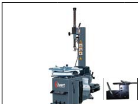
półautomatyczna montażownica LC890; ręczny odchyl ramienia na bok; wsteczny bieg; ręczne opuszczanie i blokowanie głowicy; 12°-23° (moc. od wew.); 10°-20° (moc. od zew.)
