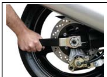
klucz do odkręcania tylnego koła; 36mm
