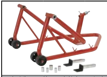
podnośnik motocyklowy pod główkę ramy (podstawa) z kpl. bolców (12,15,16,18, 20, 24mm) + dodatkowo możliwość podparcia tylnego koła
