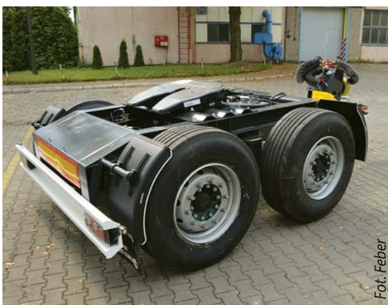
Dwuosiowy wózek Dolly z pneumatycznymi hamulcami i instalacją elektryczną umożliwiającą sprzęgnięcie ciągnika rolniczego z naczepą drogową.
