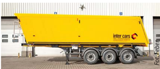
Naczepa-wywrotka do przewożenia rzepaku, buraków i zboża, objętość 42–76 m 3 , rama stalowa lub aluminiowa, skrzynia aluminiowa, zamknięcie: drzwi lub klapo-drzwi.
