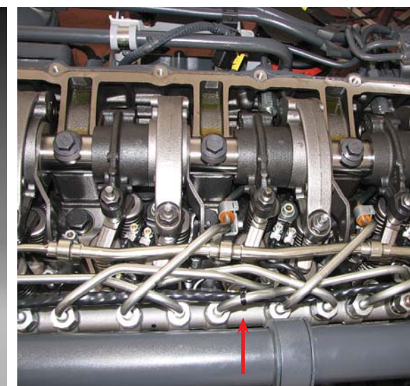
W silniku Iveco szyna common rail znajduje się pod pokrywą zaworów.
