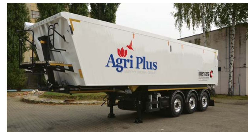
Naczepa-wywrotka do przewozu zboża, pasz i granulatów z systemem wydmuchu ładunku bezpośrednio do silosów firmy Heitling, objętość 42–52 m 3 .
