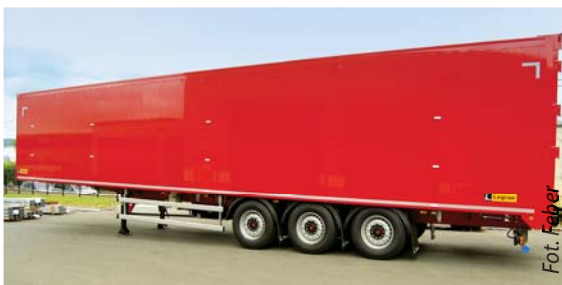
Naczepa z ruchomą podłogą Legras do przewożenia zboża, otrębów, torfu, objętość 60–91 m 3 , rama stalowa, aluminiowa skrzynia ładunkowa.
