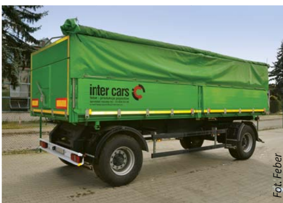
Przyczepa 2-osiowa z obrotnicą do przewożenia wszelkich płodów rolnych, ładowność 18 t, objętość 23 m 3 , rama stalowa, podłoga aluminiowa, zamykanie/otwieranie burt od dołu i od góry.
